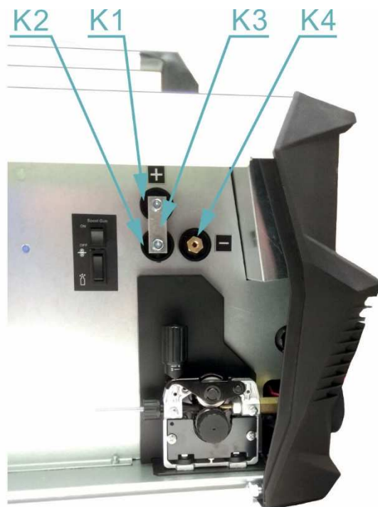
Obrázek 13. Detail terminálů změny polarity MIG/MAG hořáku
